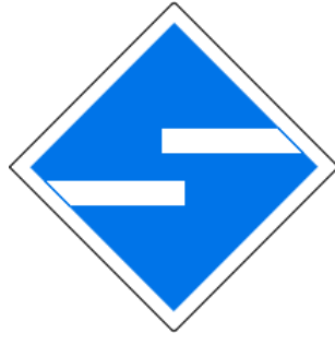
EL-3 KESİCİYİ (DİSJÖNKTÖRÜ) AÇ. PANTOGRAFI İNDİR.
